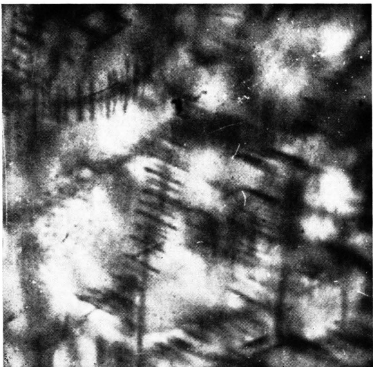
Abb. 2. Ausscheidungsverteilung in einem bei 1380 °C gesättigten Kristall. Die Abschreckgeschwindigkeit betrug 100°/sec (× 200).
