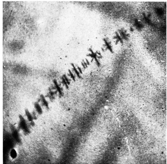
Abb. 1. Ausscheidungsverteilung in einem bei 900 °C mit Cu gesättigten Si-Einkristall in Abhängigkeit von der Abschreckgeschwindigkeit. Bei Abb. 1 a betrug die Abschreckgeschwindigkeit 100°/sec, bei Abb. 1 b 20°/sec. Vergrößerung ist 200-fach in beiden Bildern. Abb. 1 b zeigt zufällig nur eine Versetzungslinie scharf.
